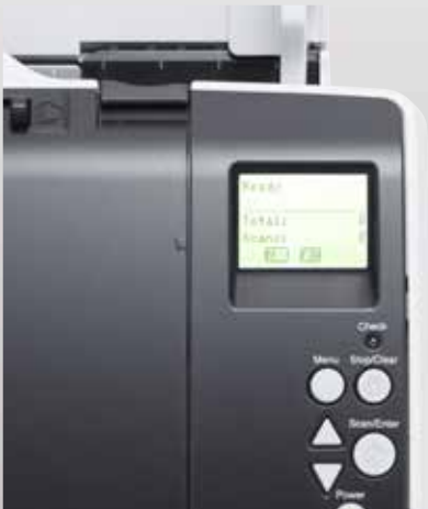
Geliştirilmiş arka ışıklı, entegre LCD çalışma paneli
